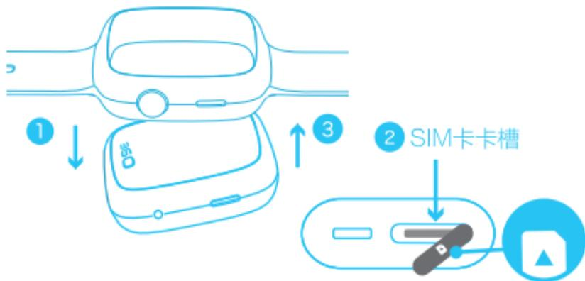
(1) 请如图示步骤1，左手托住手表底部，右手向下轻按屏幕的“360” Logo处，将表带和机身分离；
